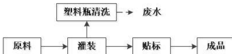
图 2-4 食用植物油工艺流程及产污环节图
