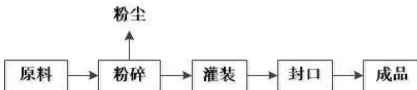
图 2-5 固态调味品工艺流程及产污环节图
